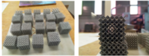
Exemples de structures lattices en polyuréthane thermoplastique (TPU).
