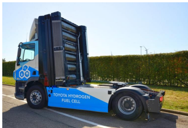
Figuur 2.14: Vrachtwagen op waterstof vanuit samenwerking VDL/Toyota
